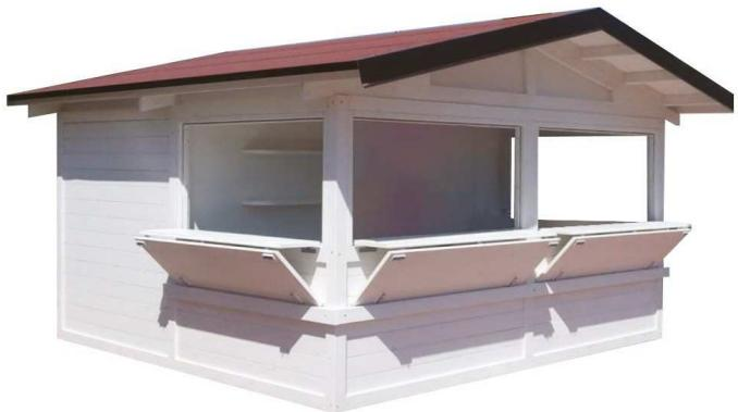
Struttura a telaio portante in abete lamellare GL24 da 100x100mm, pareti in doghe maschiate da 150x34 mm.
