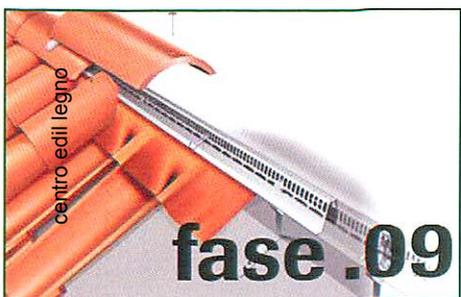
**.09** Prima della copertura finale, applicare il sottocolmo ventilato per l'uscita dell'aria calda proveniente dal sistema di ventilazione creato precedentemente.
